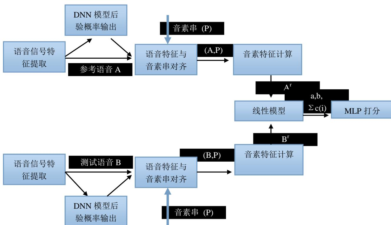
图 1: 基于线性模型的口语对比打分系统流程图
